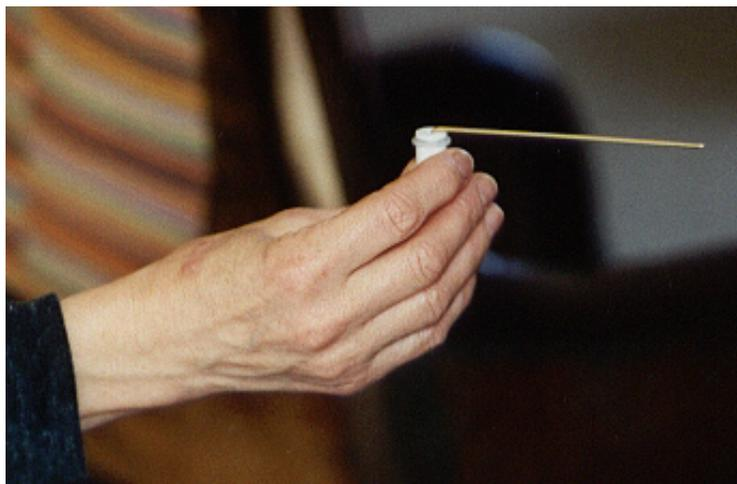
Une tige en laiton de 3 mm sur 11 cm forme l'aiguille horizontale. Une partie coudée plonge dans une poignée en plastique.
